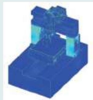
Mediante el uso de FEM (Finite Element Method) se ha determinado el análisis del diseño de la base y la colocación de los nervios de las vigas para la Quick Vision Ultra para proporcionar una óptima rigidez estructural.
