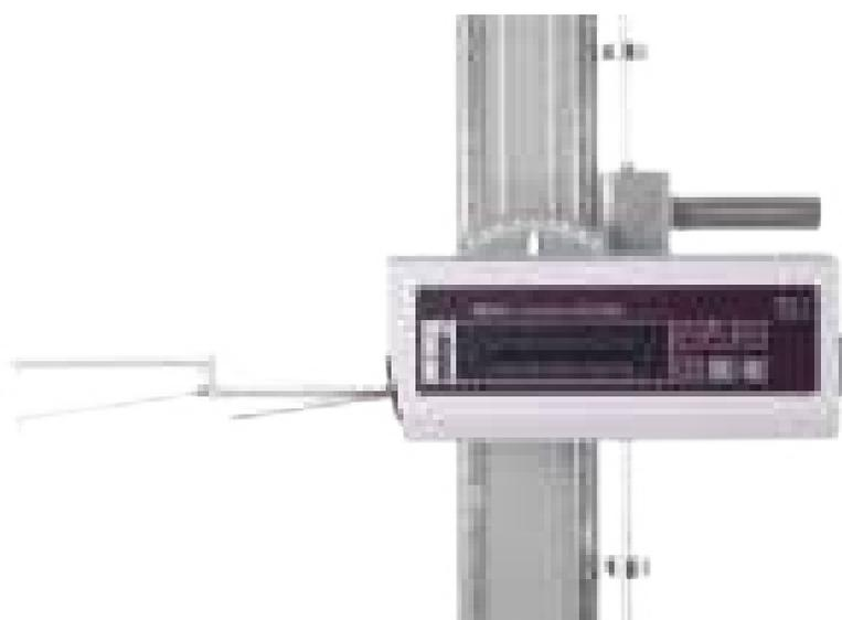
CV-2100 Palpador con función de avance y retroceso
