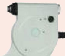
Perno de ajuste para comparador  $\pm 5$   $\mu$ m
