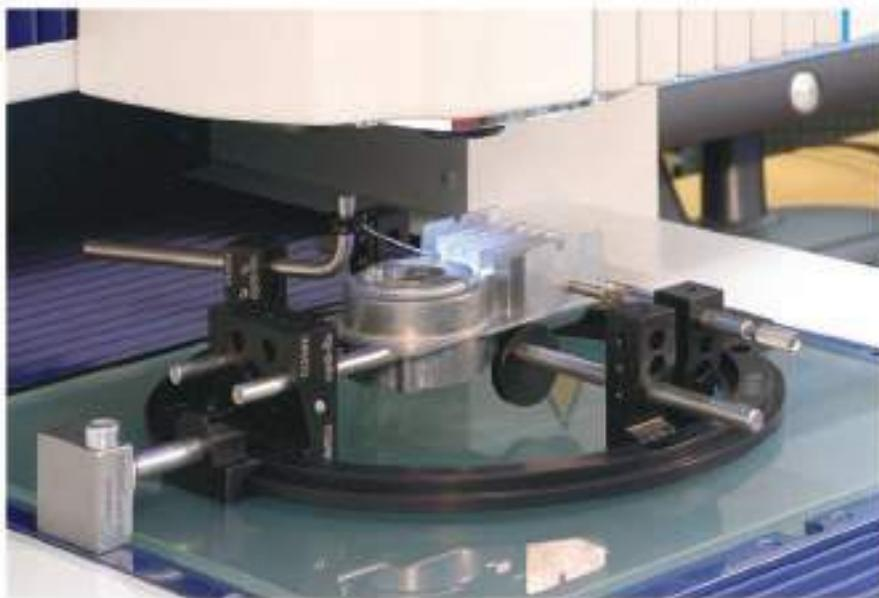
Ejemplo de aplicación para el soporte de partes prismáticas (sin el sistema de sujeción OPTI-FIX, las partes no podrían estar en posición correcta). La puesta a punto se lleva a cabo en la superficie de vidrio por una pinza magnética unida al marco de la mesa.
