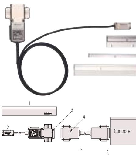
1: Escala principal; 2: Unidad Detector; 3: Conector de salida (incluido); 4: cable Feedback; 5: Para ser suministrados por el cliente (cable feedback / controlador)
