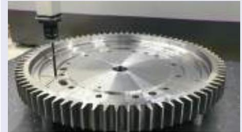
Medición en continuo con sonda SP80 y palpador 100 mm
