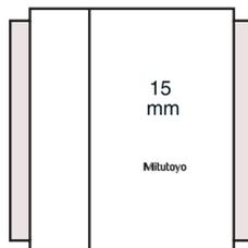
Los bloques patrón de protección (marcados arriba en gris) se colocan en el exterior de los conjuntos de bloques montados para que puedan absorber el posible desgaste causado por el roce con las piezas a controlar.
