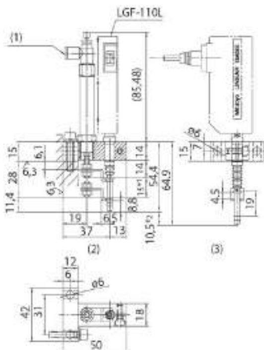
Para medidor lineal con un rango de 10 mm
