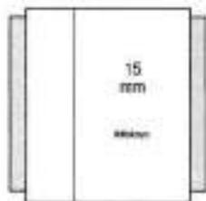
Bloques patrón de protección (resaltado en gris arriba) que se colocan en cada extremo de la pila de bloques patrón para absorber el desgaste por el contacto con piezas de trabajo.
