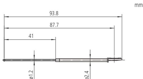
Para rugosidad de rodillos y ondulación [longitud doble]
