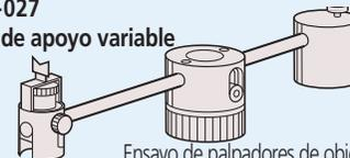
Ensayo de palpadores de objetos largos (utilizado junto con el yunque)
