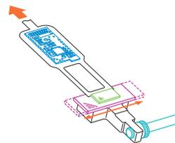
Incluso en mediciones con alargador de 2m la precisión está asegurada por que la transmisión del valor de medida es electrónica.
