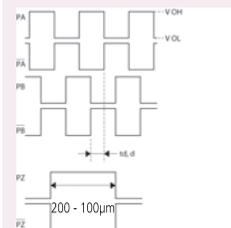
Dos señales sinusoidales de 90° de fase desplazada
