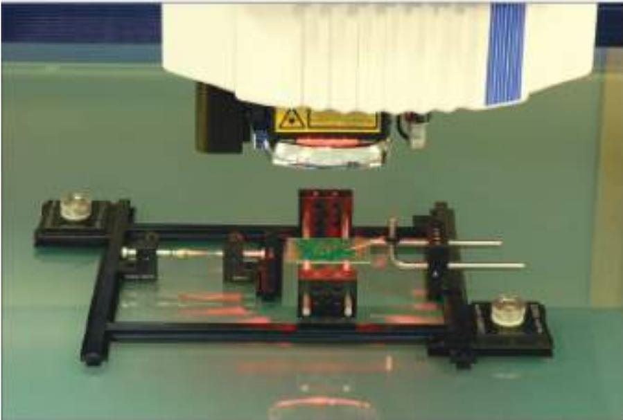
Tarjeta electrónica levantada para dar claridad a los componentes en su parte inferior. Situado directamente sobre la mesa de vidrio de la máquina sin el sistema de sujeción OPTI-FIX, la tarjeta electrónica no estaría plana. La puesta a punto se lleva a cabo en la superficie de vidrio con 2 ventosas.
