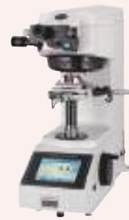
**Durómetros Vickers, Serie HV**
