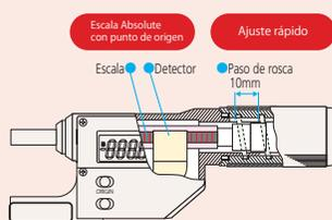
Este micrómetro está equipado con un mecanismo de avance que le permite un desplazamiento del husillo de 10 mm/vuelta. Por lo cual el avance es 20 veces superior a los micrómetros convencionales
