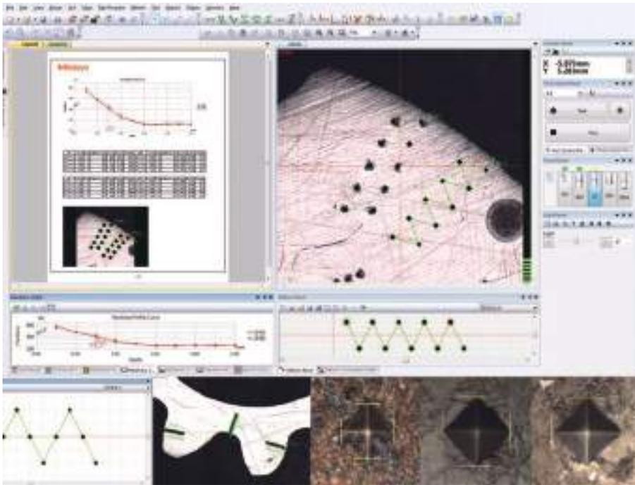
El diseño de la pantalla para el control, estado de la prueba, y pantalla de resultados se pueden cambiar libremente.
