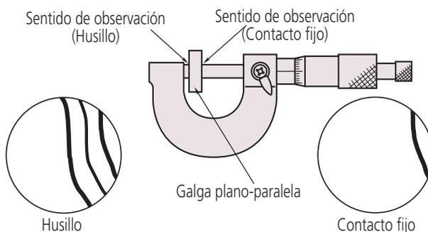
Prueba de planitud y el paralelismo de las caras de los contactos de un micrómetro: se observa la planitud por la rectitud y el espacio regular de franjas de interferencia, y el paralelismo por en n° de franjas de interferencia visibles.
