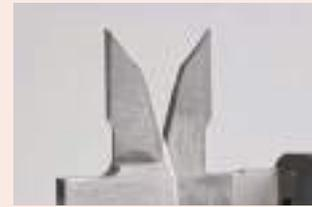
Superficie de medición de metal duro
