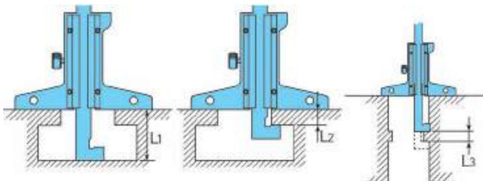
L1 = Lectura de calibre de profundidad / L2 = Lectura de calibre de gancho / L3 = (Lectura de calibre de profundidad) - (Lectura de calibre de gancho)
