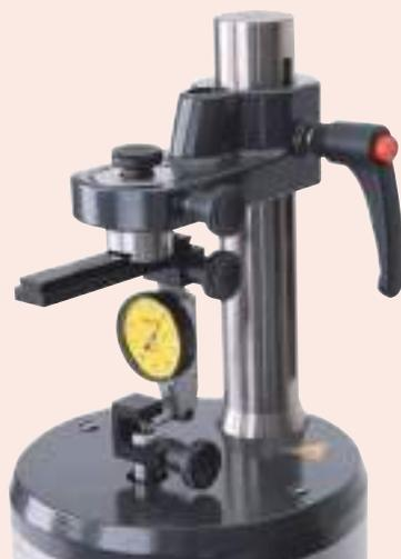
Calibración de comparador de palpador oscilante
