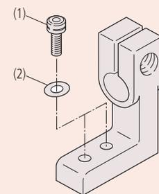
Fijaciones para cabezas micrométricas con vástago plano, se colocan y fijan por medio de un tornillo prisionero (M3x0.5x12 mm).
