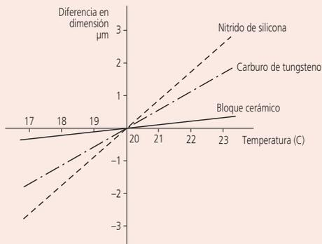
La diferencia de dimensiones entre el acero y otros materiales se obtiene en la medida de piezas con un 100mm en cada franja de temperatura.
