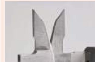
Bocas equipadas con placas de Metal duro para mediciones exteriores e interiores
